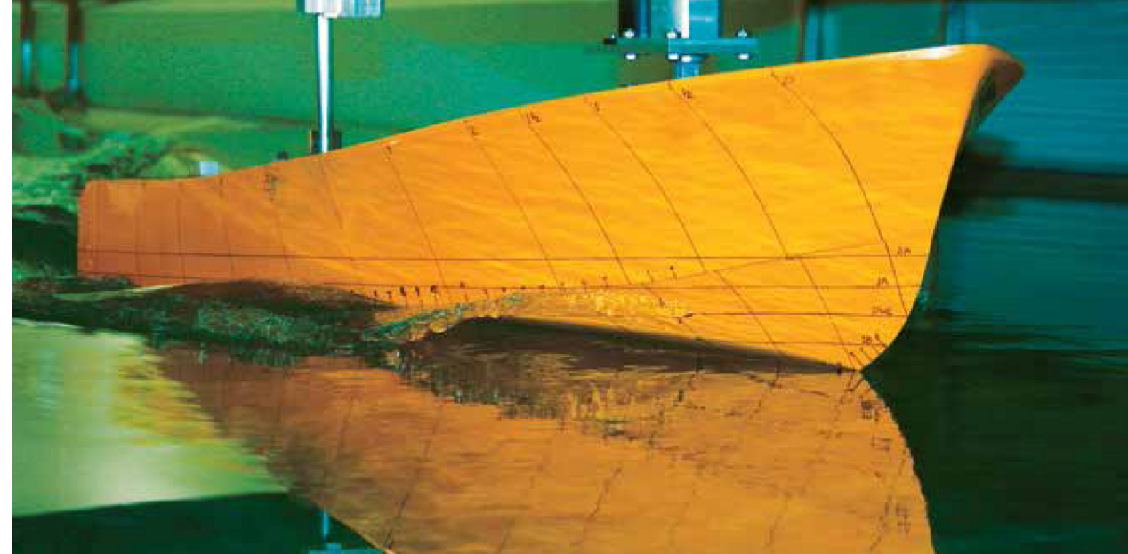
O sistema desenvolvido pelo americano Savitsky consegue calcular empuxo, arraste e a localização do centro de pressão em cascos para várias velocidades.
