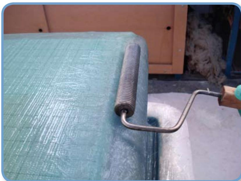
**A** fibra de vidro que normalmente se utiliza na fabricação de barcos é conhecida por nomes diferentes, mas que, na verdade, significam a mesma coisa. Você poderá escutar termos como fibra de vidro, fiberglass, plástico reforçado com fibra de vidro ou suas abreviaturas FRP, GRP ou PRFV. Em todos os casos esses termos e abreviaturas significam a utilização de fibras de vidro em conjunto com uma resina.
